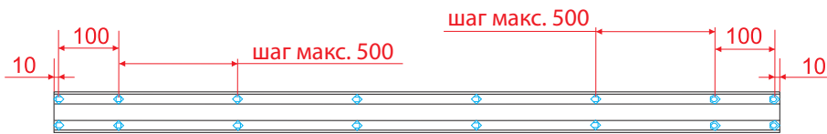
Схема крепления ребер жесткости
