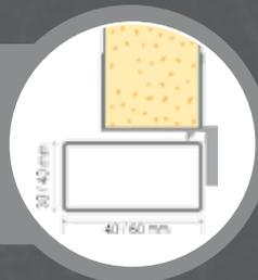
Плоский порог из оцинкованной стальной полосы. Уплотнитель в виде щетки
